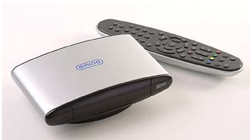
Obr. 5.5 – Príklad moderného set-top-boxu, vyniká malými rozmermi a zaujímavým tvarom, podporuje obrazové formáty MPEG-2 aj MPEG-4, vysoké rozlíšenie HDTV, obsahuje rozhranie HDMI a ochranu proti kopírovaniu HDCP (zdroj: www.aminocom.com )
